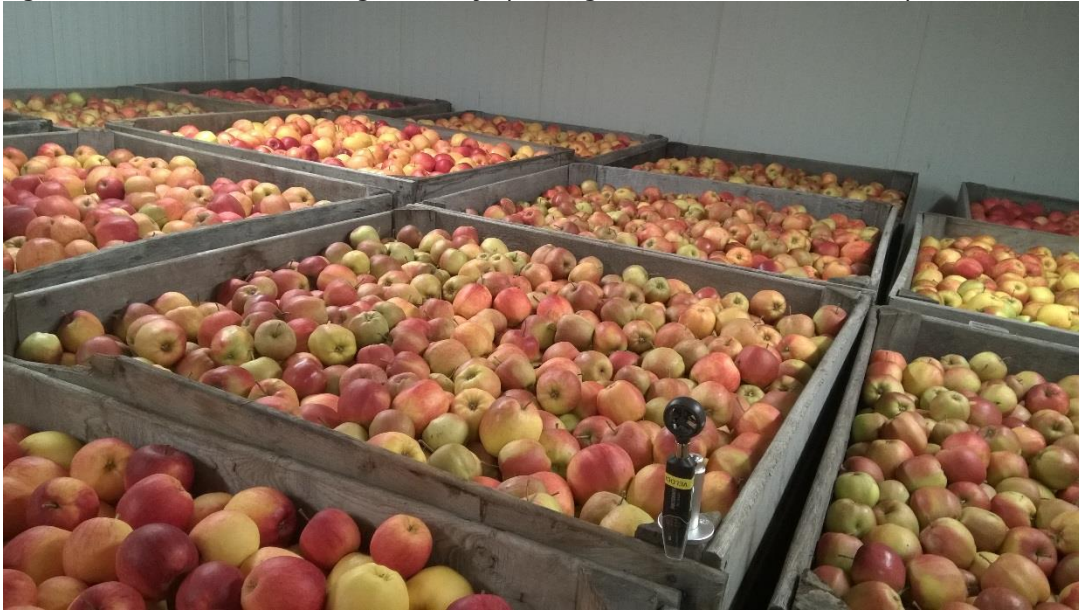
Figuur 3: Meting van de luchtsnelheid boven in de luchtstroom
